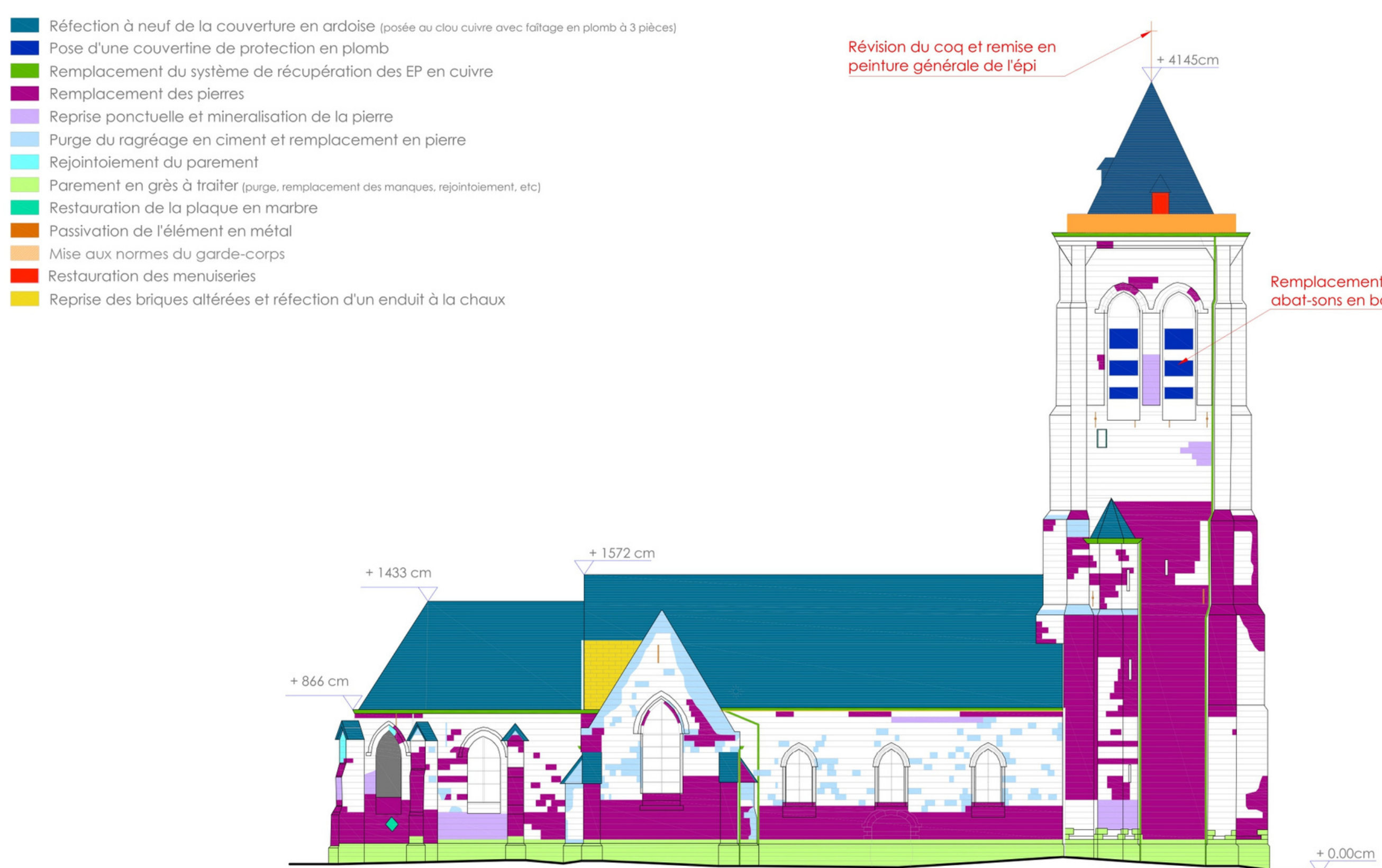
Préconisations - façade NORD
